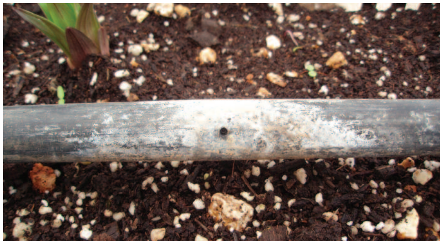
Σύστημα άρδευσης με σταγόνες σε υδροπονική καλλιέργεια και εναπόθεση αλάτων στο σημείο ενστάλαξης της σταγόνας
